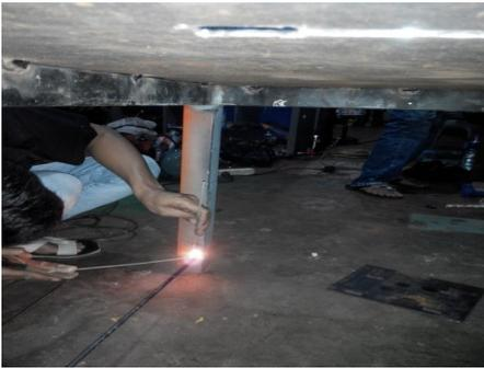
Gambar 7 Pengelasan kaki rangka
